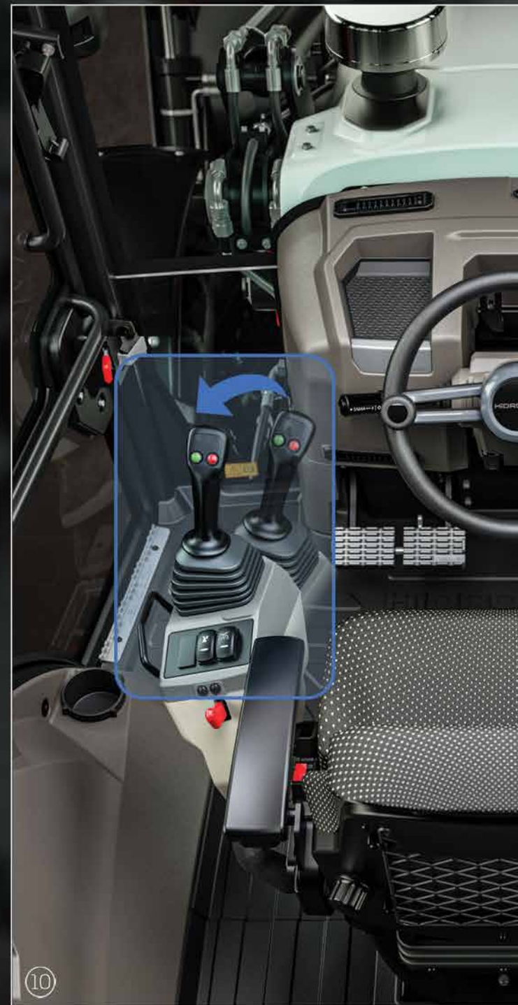
10 Neigung des linken Joysticks, damit der Bediener bequemer auf der Lader-Seite arbeiten kann
